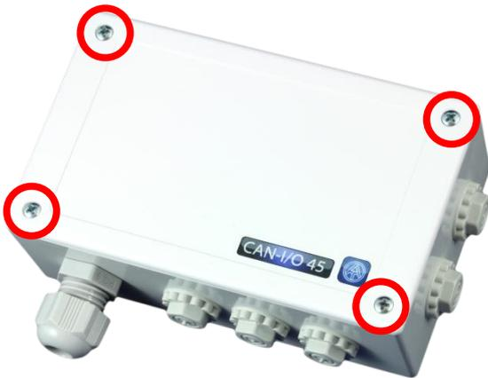
Die 4 Schrauben an der Vorderseite lösen und den Deckel abheben.
