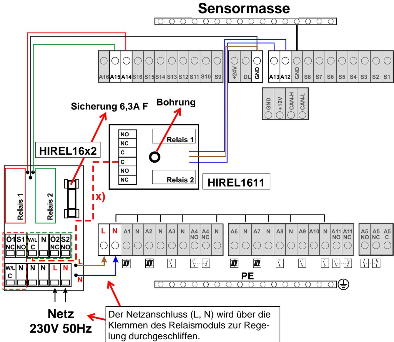
**x)** Mit dieser Verbindung können die Relaiskontakte den Außenleiter (230V) durchschalten. Dadurch sind die Relaisausgänge nicht mehr potentialfrei. Sie sind durch die Sicherung des HIREL16x2 abgesichert.
